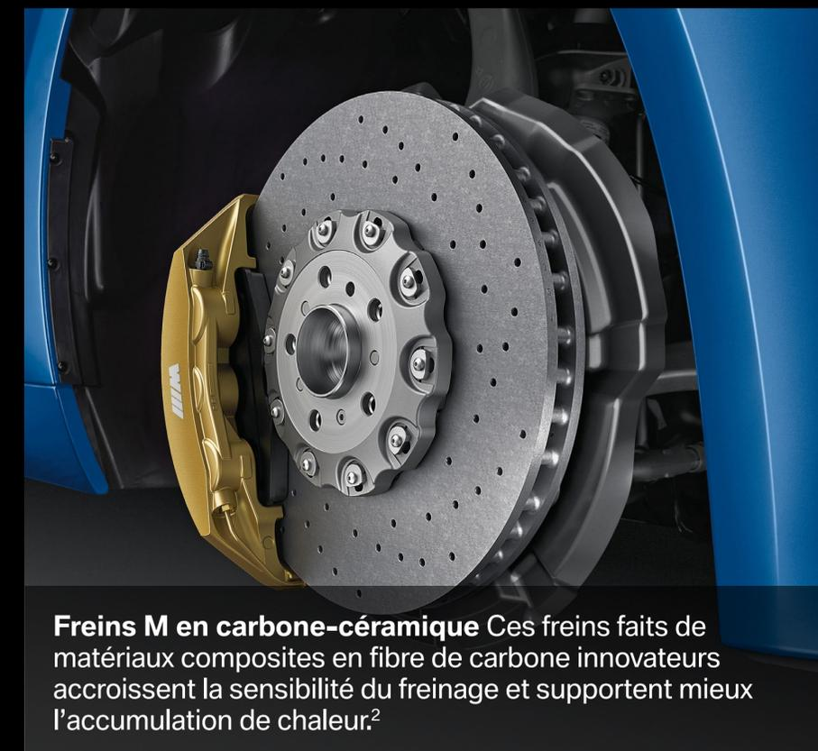
**Freins M en carbone-céramique** Ces freins faits de matériaux composites en fibre de carbone innovateurs accroissent la sensibilité du freinage et supportent mieux l'accumulation de chaleur.<sup>2</sup>
